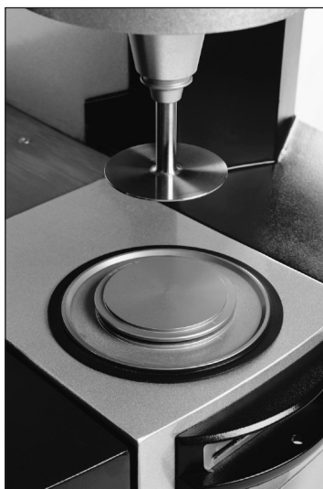
Fig. 1.10 A rotating parallel-disk rheometer (NETZSCH).
