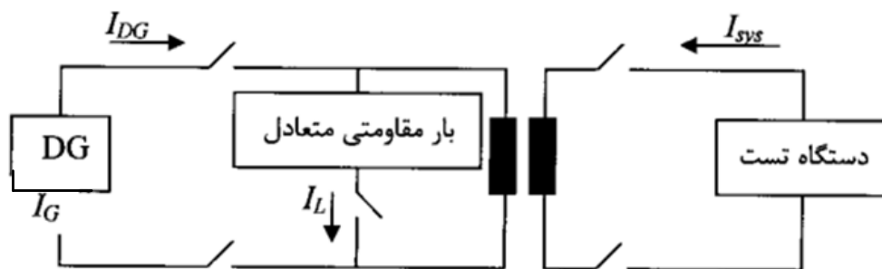
شکل (۲-۴): انجام تست هارمونیک در ژنراتور سنکرون
